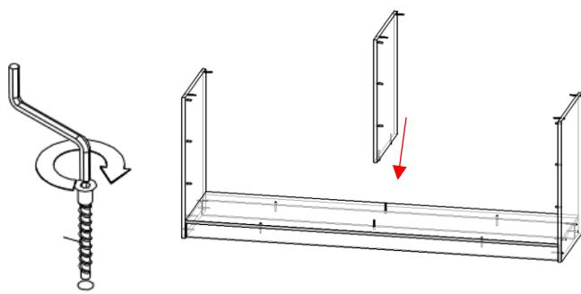
**3. Соединяем крышу шкафа с боковинами и перегородкой.**
